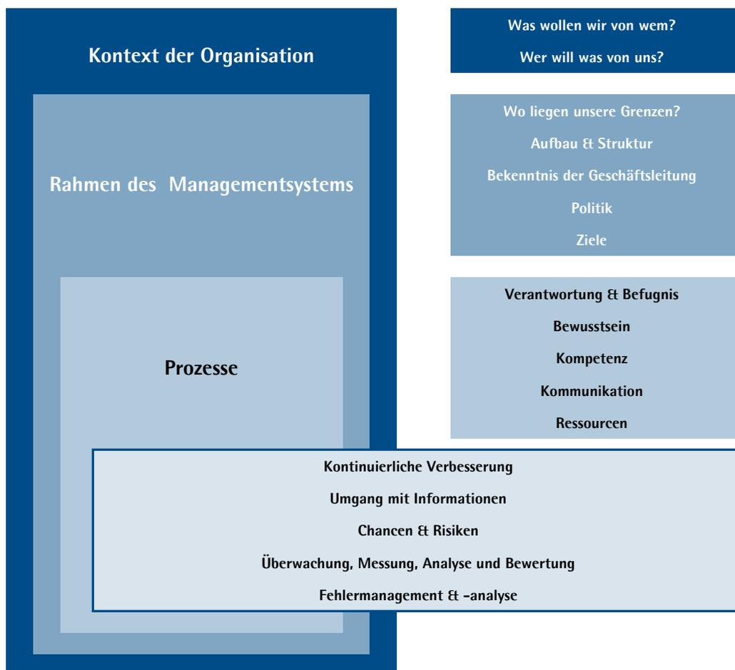
Abbildung 7 Allgemeine Struktur eines Managementsystems nach DIN EN ISO 9001:2015.
