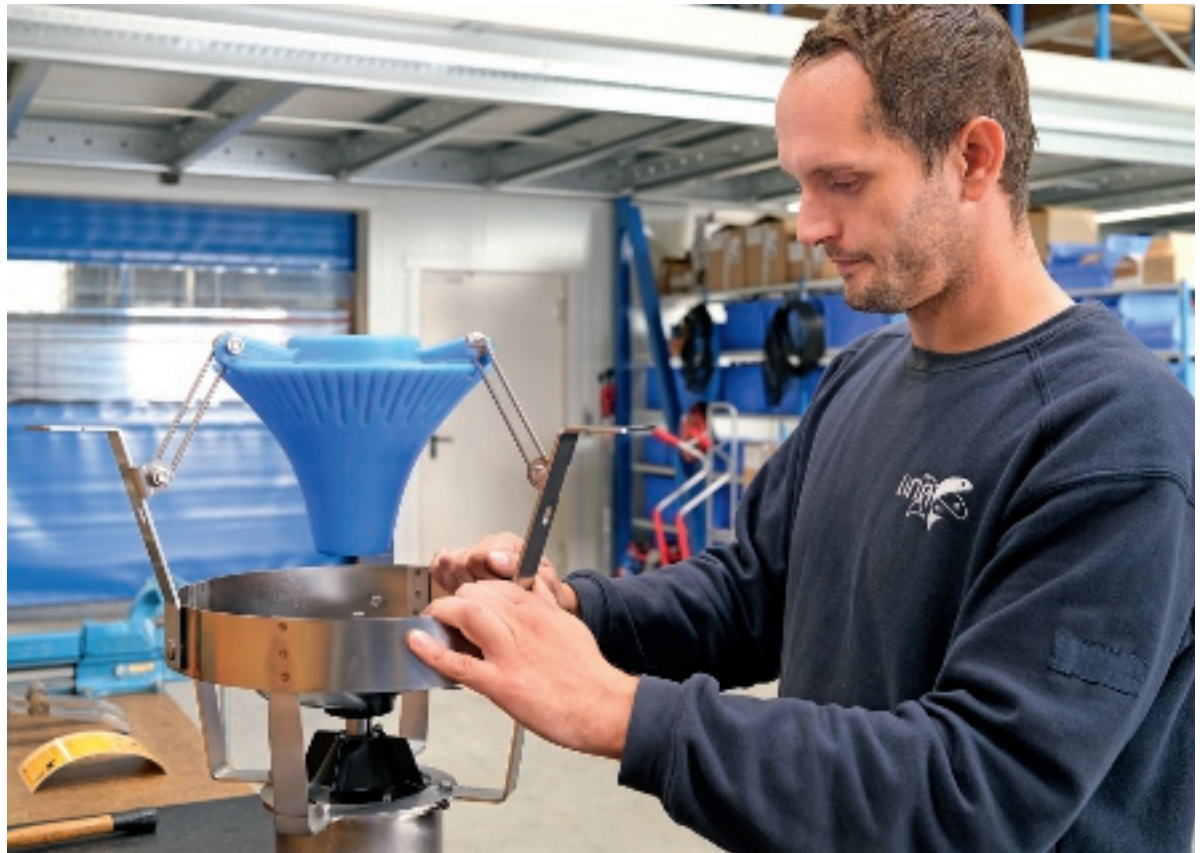
Konzentriert bei der Arbeit: ein Beschäftigter des Unternehmens bei der Montage eines Wasserbelüfters.
